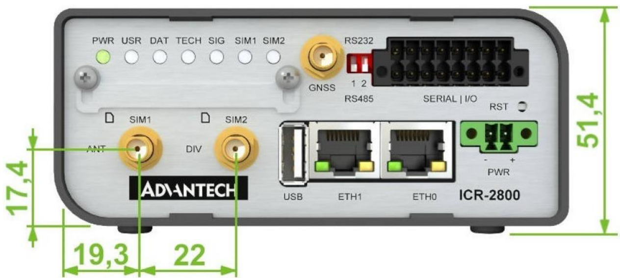
Rys. 8 Obudowa z tworzywa sztucznego – panel przedni
