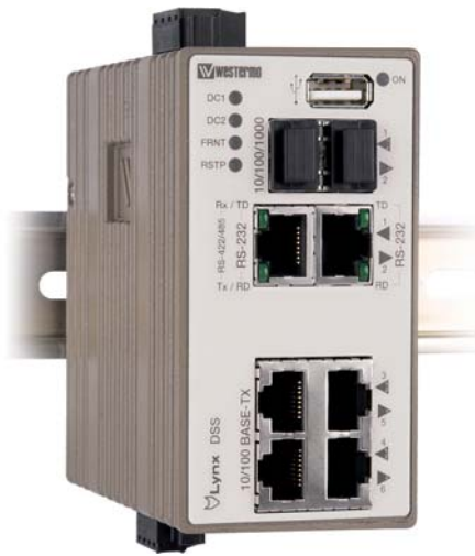
Ilustracja 2. Switch warstwy 3 z funkcją distributed micro-firewall, serwerem portów szeregowych. Westermo Lynx208-F2G-S2.
